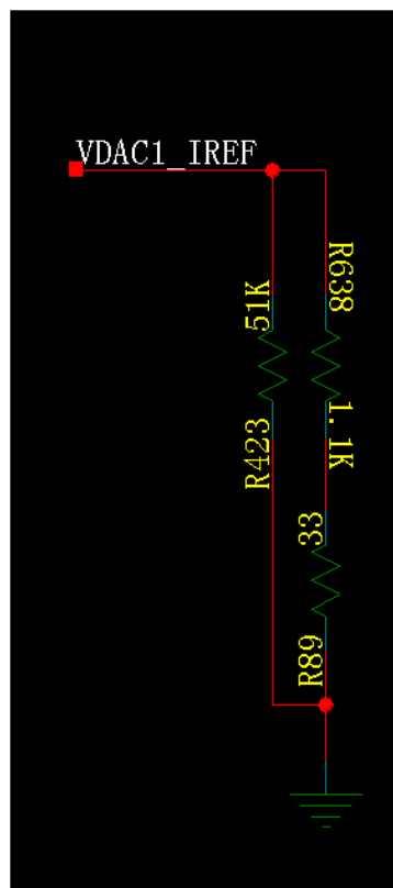
图2-3 VGA 配置电阻 R423 和 R638 的阻值示意图
